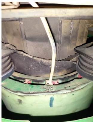
Fotos 2, 3 e 4: Enrolamentos 1, 2 e 3 do transformador 750 kVA, avariados.
