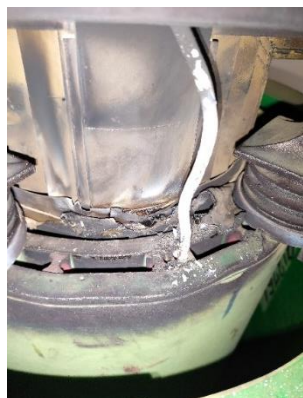
Fotos 2, 3 e 4: Enrolamentos 1, 2 e 3 do transformador 750 kVA, avariados.
